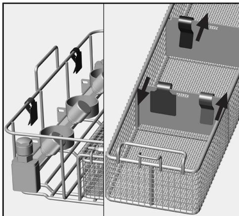
Прикрепите бирки одного цвета на каждом кольцевом держателе или креплении для обрабатываемого материала и бирки такого же цвета на отсеках корзины для мелких предметов.
